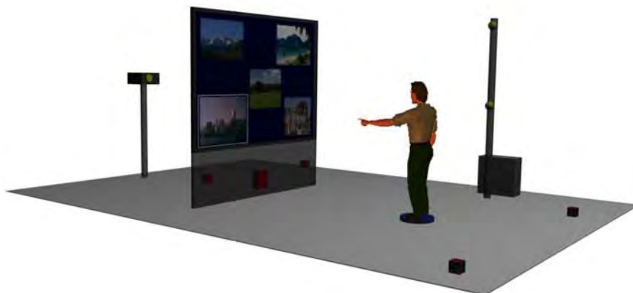
Fig. 2 – Il sistema in fase di sperimentazione è costituito da un sistema di retroproiezione, due telecamere che inquadrano lateralmente l'utente e due casse acustiche (dal sito http://pointat.info/website/index.htm )
